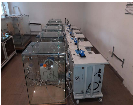
Rys. 1. Zespół sześciu komór badawczych wraz z modułami przygotowania powietrza
